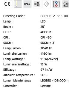
Controller : Remote Input Voltage : 24Vdc
